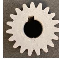
**Figure 11 - Engrenage imprimé en 3D en acier faiblement allié - 8620**
