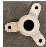
**Figure 10 - Trépied imprimé en 3D en titane - Ti6Al4V**
