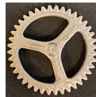
**Figure 9 - Engrenage imprimé en 3D en acier inoxydable - 17-4 PH**
